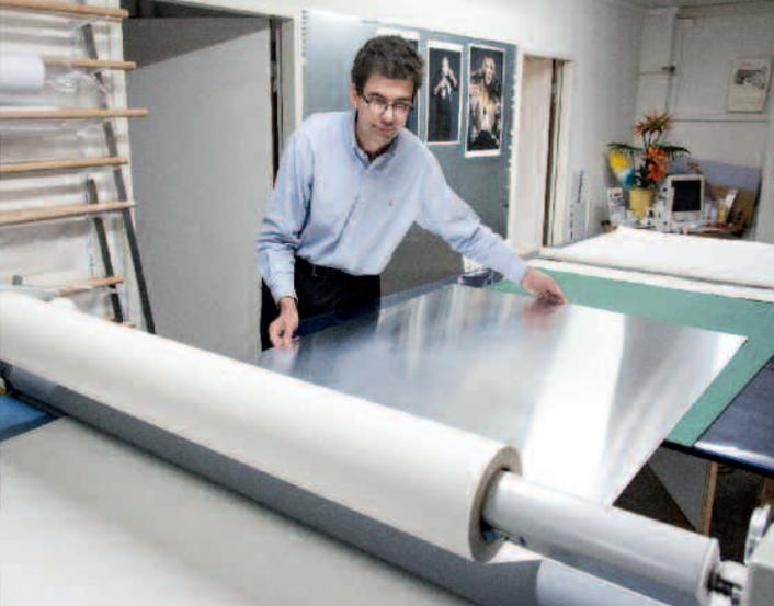
*Eine Aluplatte wird mit einer doppelseitigen Klebefolie beschichtet, danach wird der Ausdruck sorgfältig aufgezogen.*
